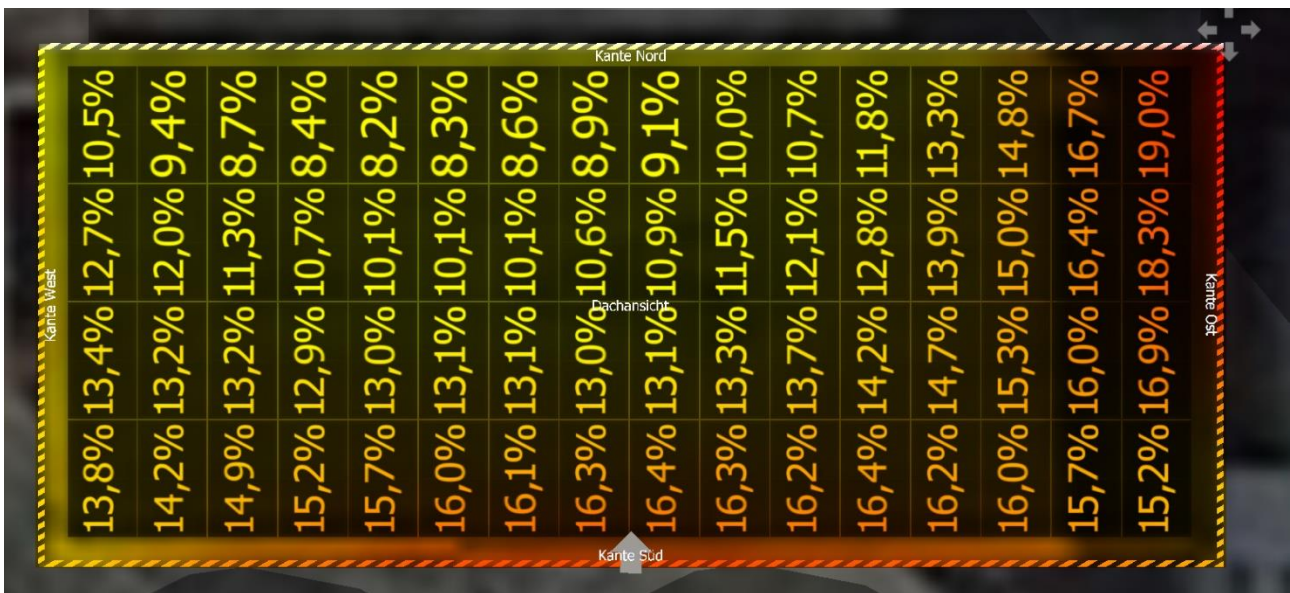
Abbildung 9: Verschattungsanalyse Flachdach III (dachparallele Module)
