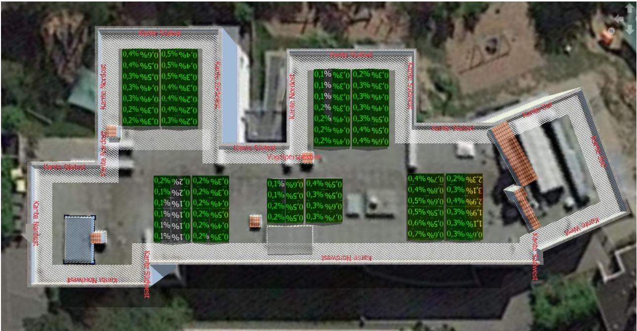
Abbildung 11: Verschattung des Flachdachs (Ost/West Aufständiger)
