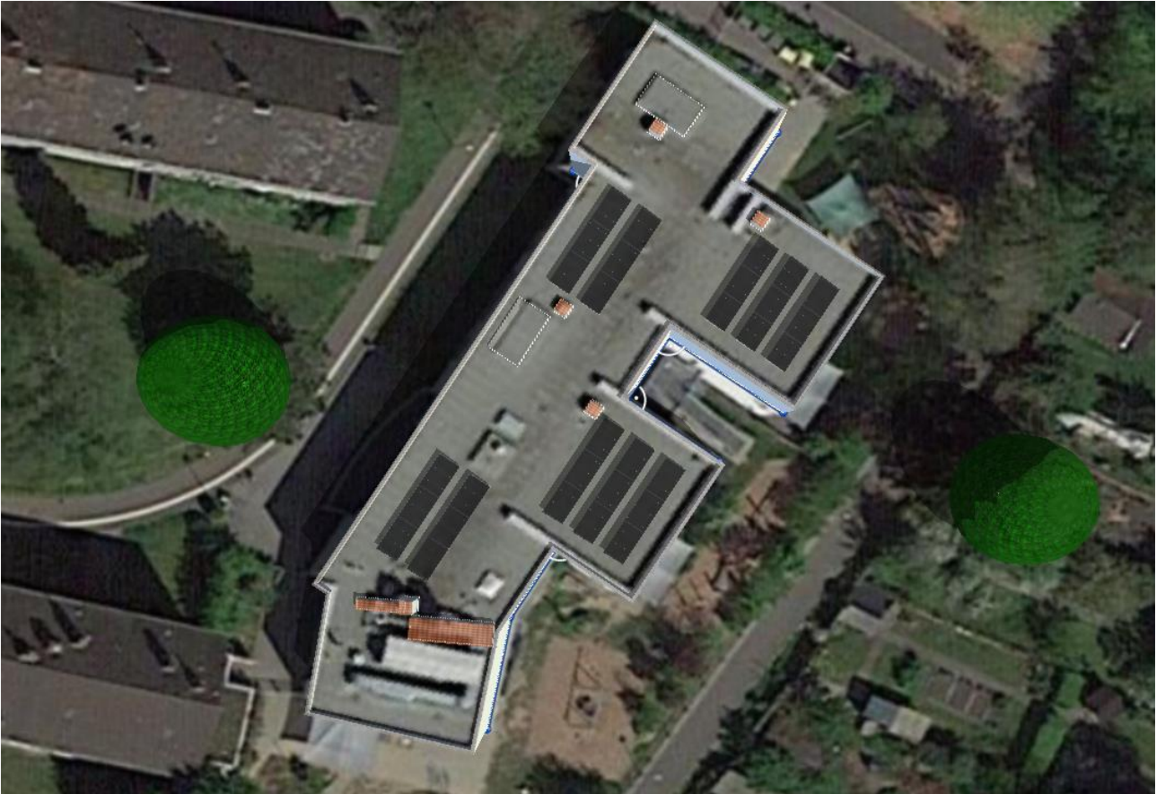
Abbildung 13: PV-Anlage – genordete Draufsicht Variante „wirtschaftlich optimiert“ (PVsol*premium)
